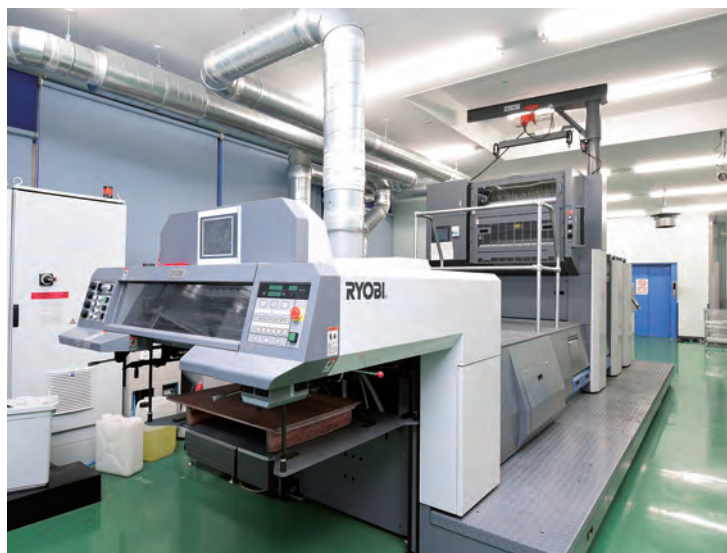
2階の専用ルームに設置されているUVキャストリング・フォイルシステム搭載751G
